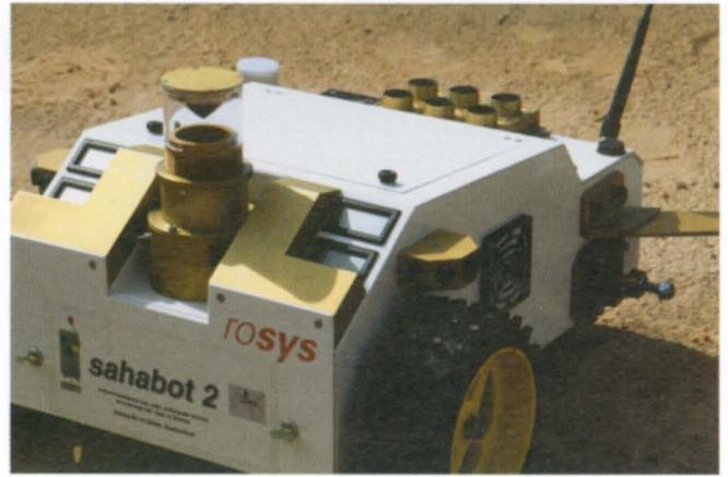
**Abb. 9.** Sahabot, ein Roboter, der wie die *Cataglyphis* nach dem polarisierten Himmelslicht Kompasskurse steuert und einen Bildkomparator zur Zielfindung nach künstlichen Geländemarken einsetzt. Im Vordergrund ist der konische Spiegel zu erkennen, über den das Landmarkenpanorama auf eine digitale 360°-CCD-Kamera projiziert wird.
